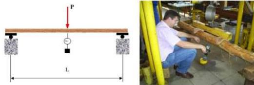
Figura 2 – Esquema estático do ensaio de peça roliça de madeira estrutural. Fonte: Foto do Autor, ensaios realizados no LaMEM em 2008.
